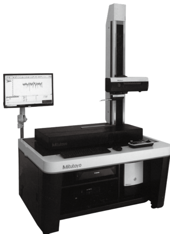
200mm驅動部、大型基座機、長柱機 表面粗度測定機 FTA-L8S3000
